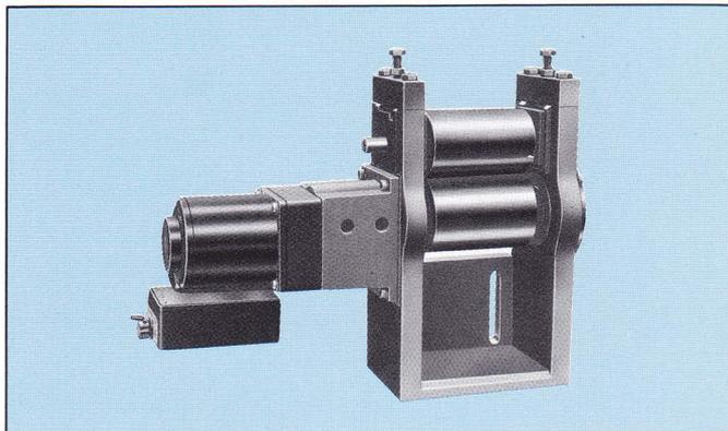
スキルダーは、従来の送り装置と併用して、板厚0.01mmの極薄から0.6mmの厚物まで精度良く送ることができる送り補助装置で、プレス順送り加工に抜群の偉力を発揮します。
